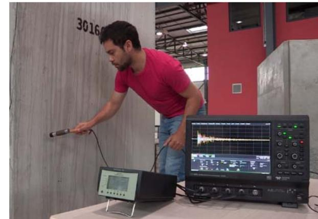
*Essais de contrôle non destructif au CMHM sur un conteneur MAVL dans le cadre du projet DCND*
