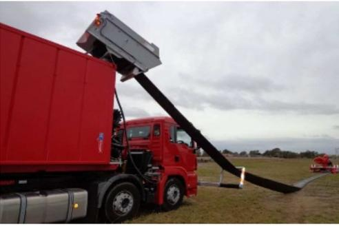
3) Relevage des tuyaux par dispositif assisté
