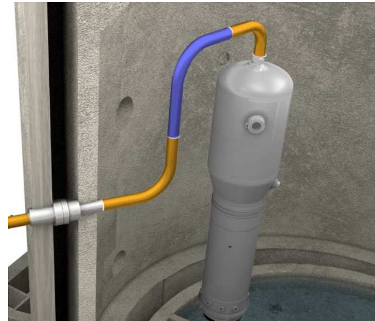
Traversée de l'enceinte
