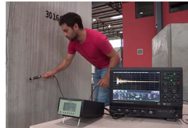
Essais de contrôle non destructif au CMHM sur un conteneur MAVL dans le cadre du projet DCND
