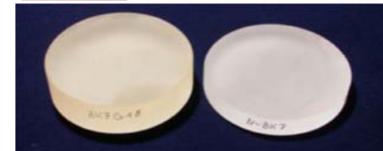
Noircissement des optiques sous l'effet de l'irradiation
