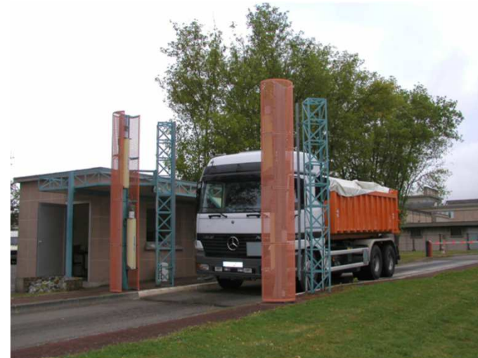
Portiques de contrôle radiologique des chargements de véhicules (CRCV)
