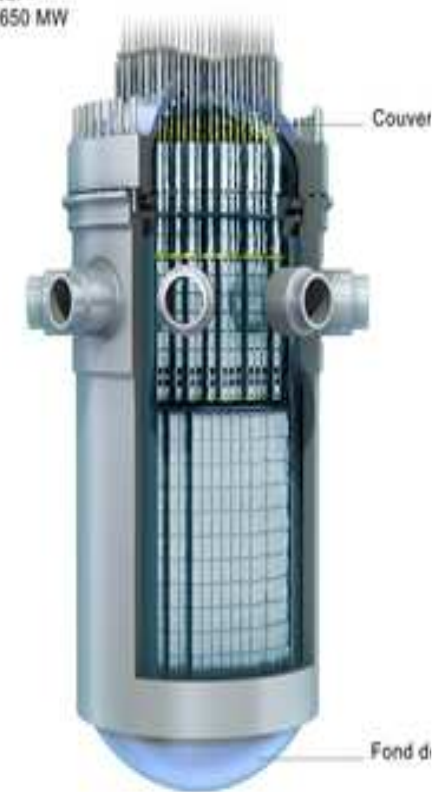
Cuve de réacteur de type EPR 1650 MW
