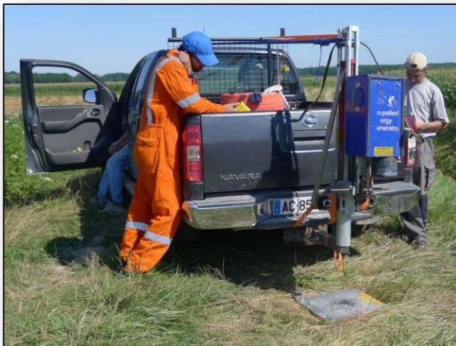
*Acquisition sismique réfraction*
