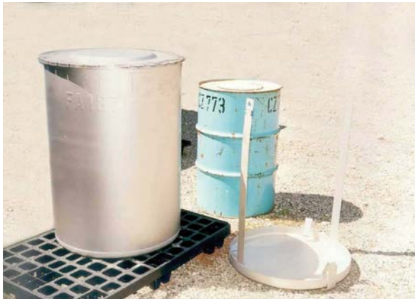
Fût enrobé bitumineux (à gauche : surfût inox)
