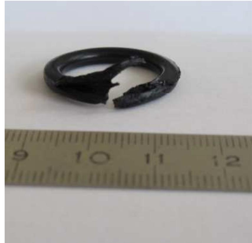
**L'expertise menée montre un serrage insuffisant d'une des quatre vis qui maintiennent la bride du joint extrudé.**
