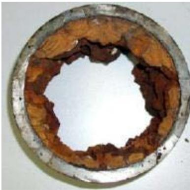
Tartre radioactif déposé sur une canalisation industrielle
