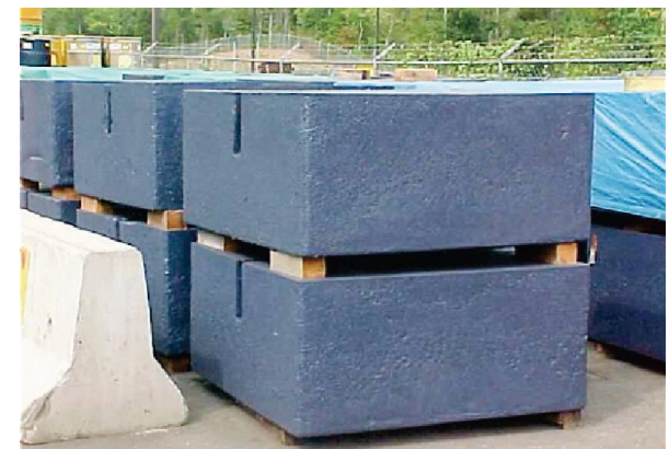
EnergySolutions. Blocs de protection pour laboratoire de physique (haute énergie)
