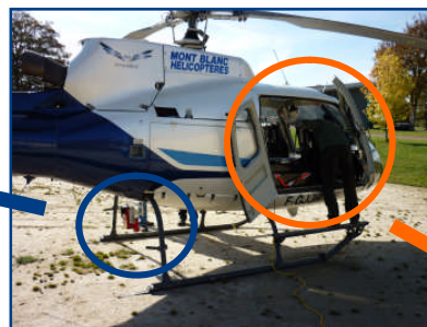
2 spectromètres RS-500 ADS 1024 canaux
