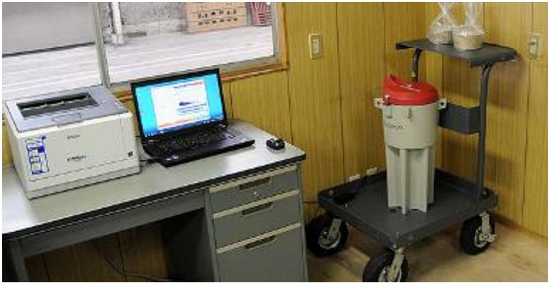
Système clé en main de contrôle rapide des produits alimentaires transformés ou naturels non traités pour les radionucléides recherchés suite à un accident radiologique ( $^{131}\text{I}$ ,  $^{134}\text{Cs}$  and  $^{137}\text{Cs}$ )
