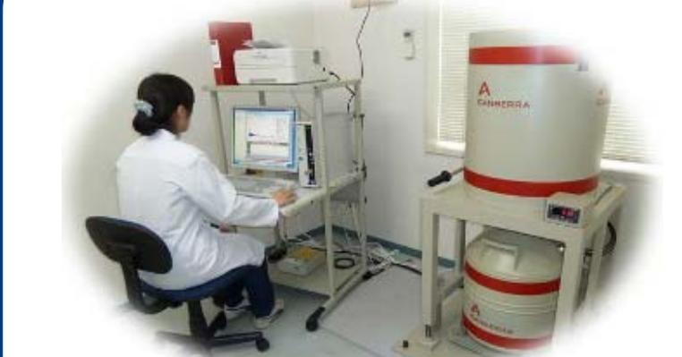
Système clé en main capable d'identifier et de quantifier tous les radionucléides présents dans un échantillon
