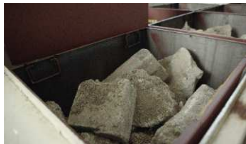
Gravats TFA (démantèlement)
